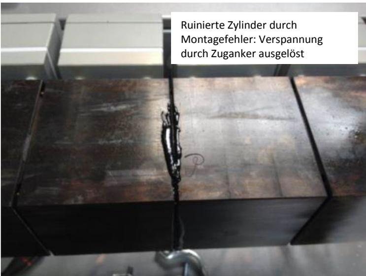
Ruinierte Zylinder durch Montagefehler: Verspannung durch Zuganker ausgelöst
