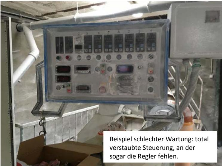
Beispiel schlechter Wartung: total verstaubte Steuerung, an der sogar die Regler fehlen.
