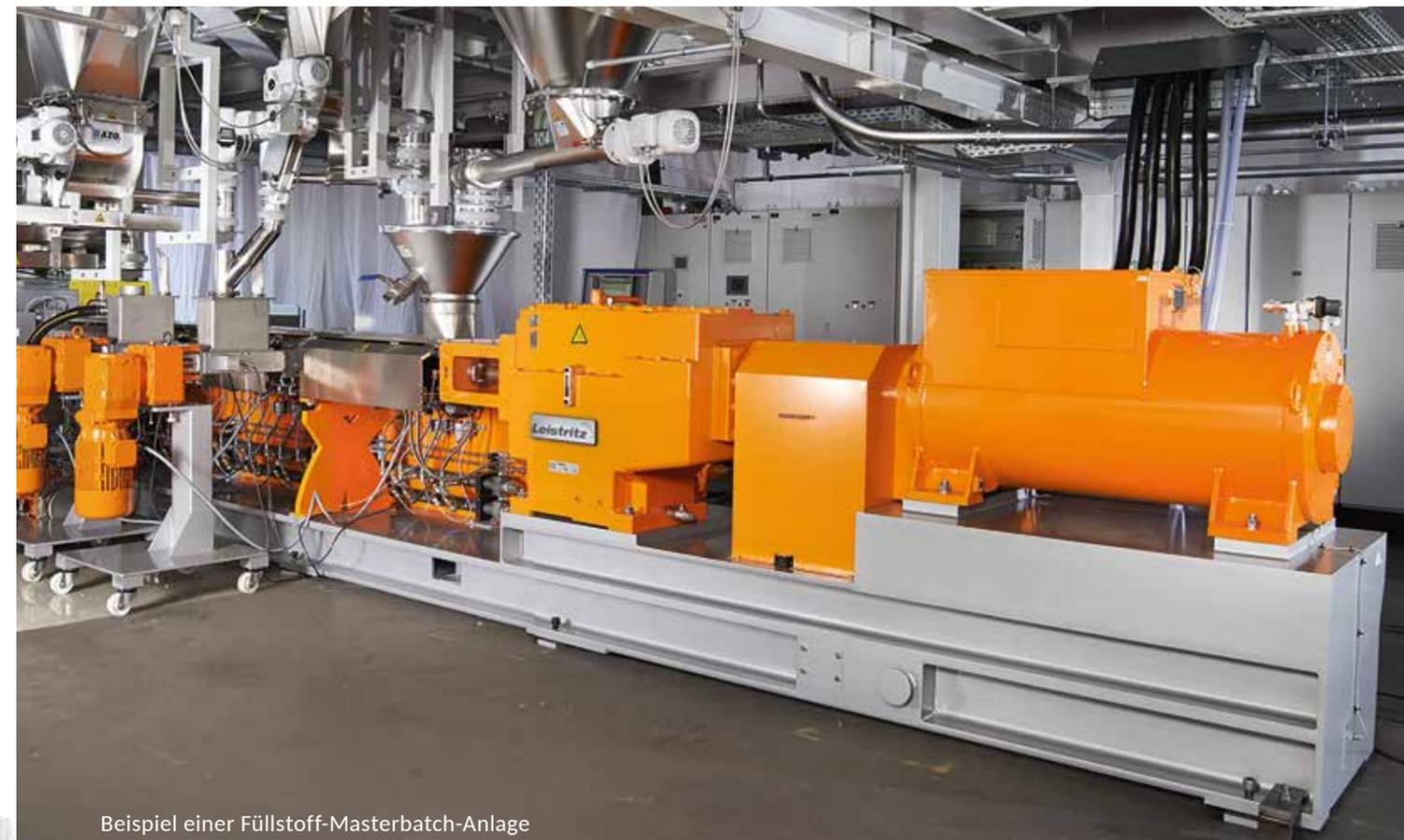
Beispiel einer Füllstoff-Masterbatch-Anlage
