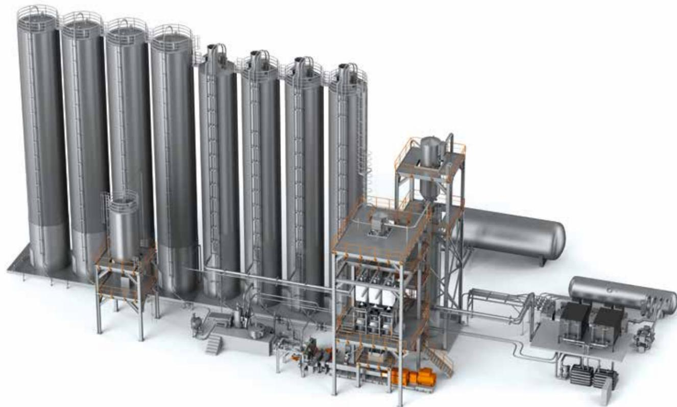
**Beispiel Großprojekt:** D-Visualisierung einer Compoundier-Anlage zur Stabilisierung von PP-Pulver direkt aus der Polymerisation
