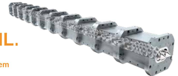
Die Auslegung der Schneckengeometrie und des Zylinders ist genau aufeinander abgestimmt. *Leistritz* bietet Zylinder mit verschiedensten Öffnungen und Einsätzen für Materialzuführung, Entgasung und Entlüftung zum optimalen Zusammenspiel mit den Extruderschnecken. Je nach Maschinengröße werden diese aneinander geflanscht oder durch Zuganker verbunden.
